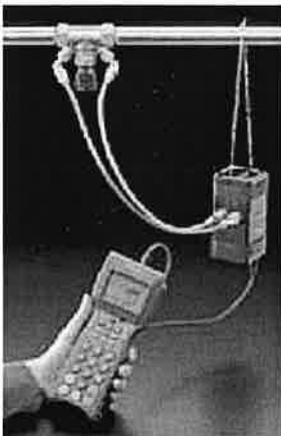
Vanne d'équilibrage à placer sur un circuit de distribution. En mesurant et en réglant la perte de charge de la vanne, on ajuste le débit irriguant le circuit à sa juste valeur.
